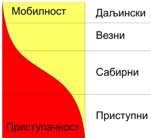
Слика 1. Однос функционалне класификације пута и ојслуживања мобилности и приступачности
