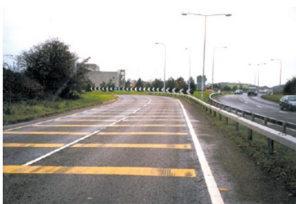
Слика 1: Обезбеђивање позитивног вођења - а) б) табле за усмеравање в) издигнути маркери у коловозу
