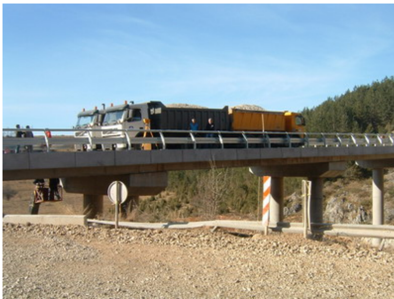
Слика 12. Пробно оптерећење на мосту 7
