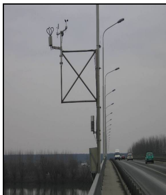
Slika 1b: Putna meteorološka stanica na mostu
